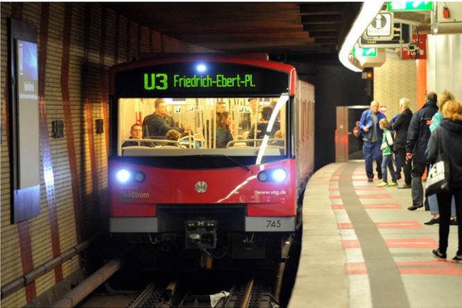
Abb. 10: Autonome U-Bahnlinie "U3" in Nürnberg
